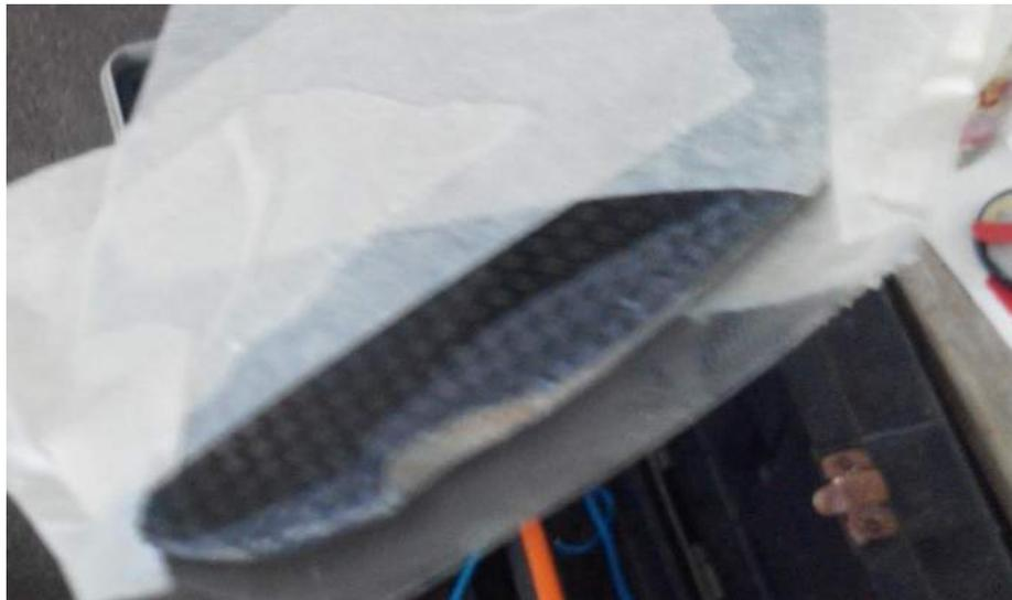
La résine ne doit pas coller sur ce support. Pour cela, l'enduire de cire (de démoulage ou de parquet).
